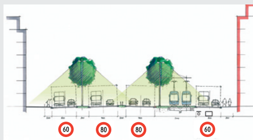
Abbildung 3: Raum Thurgauerstrasse mit der Glattalbahn in «Seitenlage»
