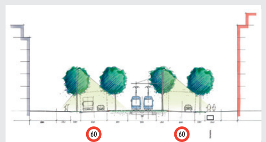
Abbildung 4: «Neue» Thurgauerstrasse mit 4 Fahrstreifen
