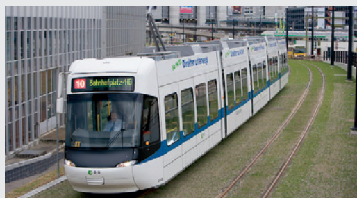
Abbildung 4: Gleis im Eigentrassee mit Schotterrasen (Typ Ba)
