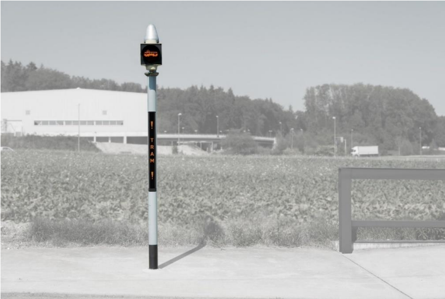
Das von VBG und BURRI public elements entwickelte Warnsignal (in der Mitte des Signalmasts). Fotomontage ©BURRI public elements
